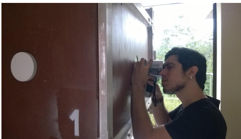
Figura 68: Leitura de Luminâncias no interior da célula.
