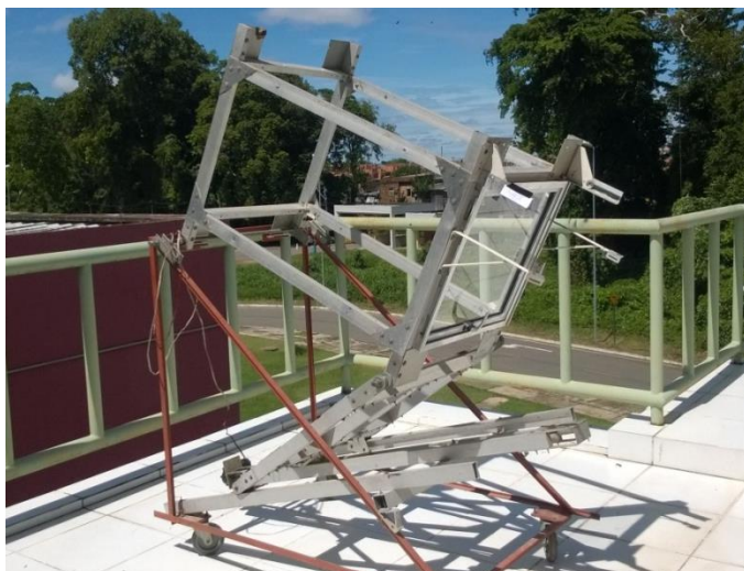
Figura 63: Estrutura metálica da célula de testes sem fechamentos opacos.
