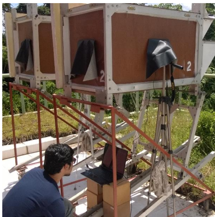
Figura 74: Acionamento remoto das câmeras por meio de um computador.
