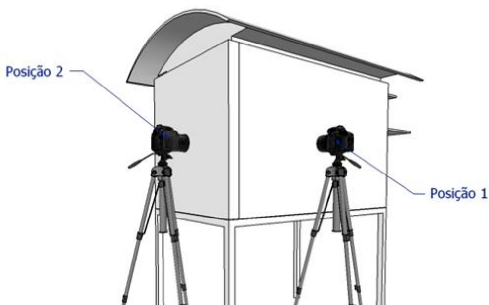
Figura 73: Representação esquemática das posições da câmera para obtenção das imagens em HDR.
