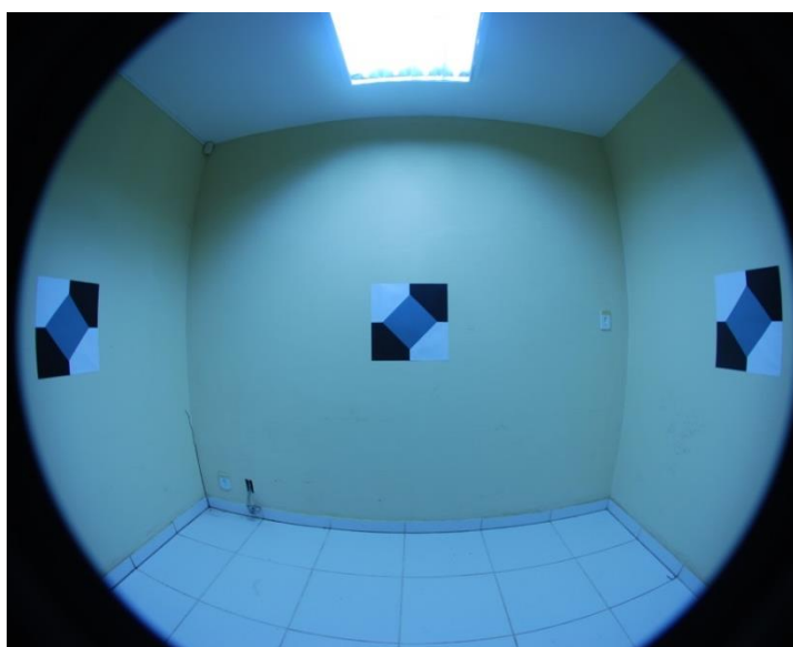
Figura 66: Disposição dos quadros de papel no interior da sala. Foto feita com a câmera Nikon D60 com a lente Sigma.
