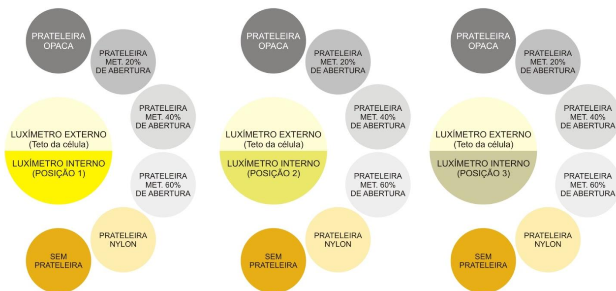
Figura 86: Baterias de registros de valores de iluminâncias, para FLD, em função da posição do luxímetro interno.
