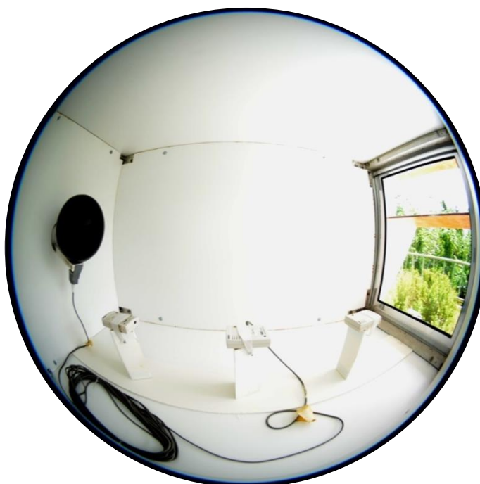
Figura 77: Interior de uma das células com os equipamentos de medição e coleta de dados posicionados.
