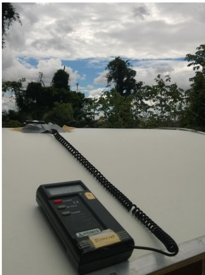
Figura 83: Luxímetro externo (No: 080702168) fixado no teto da célula.
